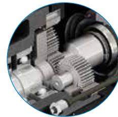
Robusto riduttore epicicloidale che consente di ottenere, con dimensioni e peso contenuti, elevati rapporti di riduzione, trasferire un alto valore di coppia e sopportare notevoli carichi radiali (solo modelli ZMR)
